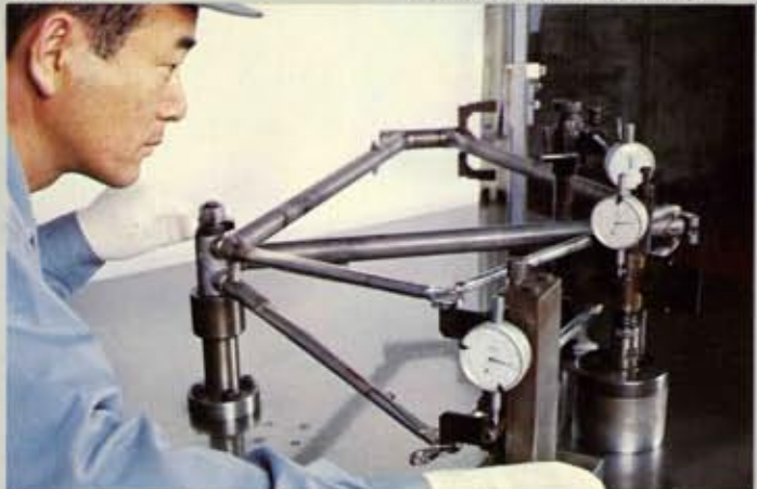
Met grote precisie worden de frame's bij Miyata in Japan "koud" gericht. Deze methode geeft veel zekerheid, maar ondanks dat wordt elk frame apart nog eens minutieus gecontroleerd.
