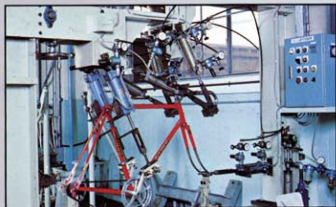
Deze foto laat een gedeelte zien van de elektronische robot die door Koga-Miyata wordt gebruikt om elk nieuw ontworpen frame grondig te testen voor aanvang van de productie. Alle omstandigheden (dus ook de zwaarste trajecten van Europa) kunnen worden nagebootst. Dat geeft zekerheid... vandaar de levenslange garantie op het frame.
