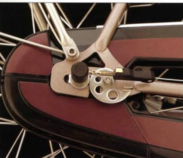
Koga-Miyata's achtervorkconstructie voor snelle montage en demontage van achterwiel en ketting spannen (RA-RAL).
