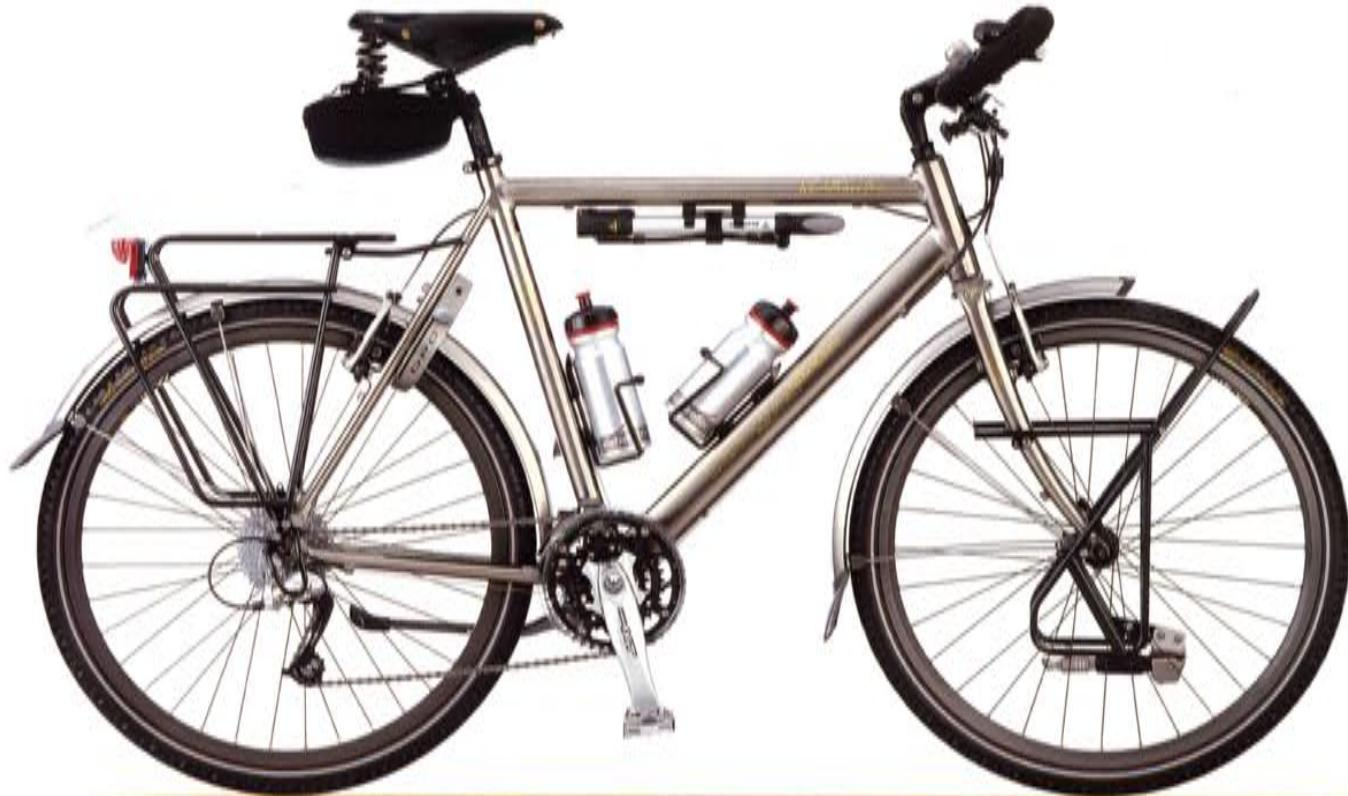
**World Traveller (WT)** Framematen 50-54-57-60cm Framemateriaal Aluminium 7005 Voorvork Aluminium Wide Bone geïntegreerd Kleurencombinatie Dark titanium brush Groep Shimano Deore XT Velgen Mavic EX 721 599-21 36g CD "enkel gebuist" Zadel Selle Royal Brooks Conquist Zwart Pedalen Shimano PD-M324 Achterdrager Tubus LOGO Low-rider Tubus
