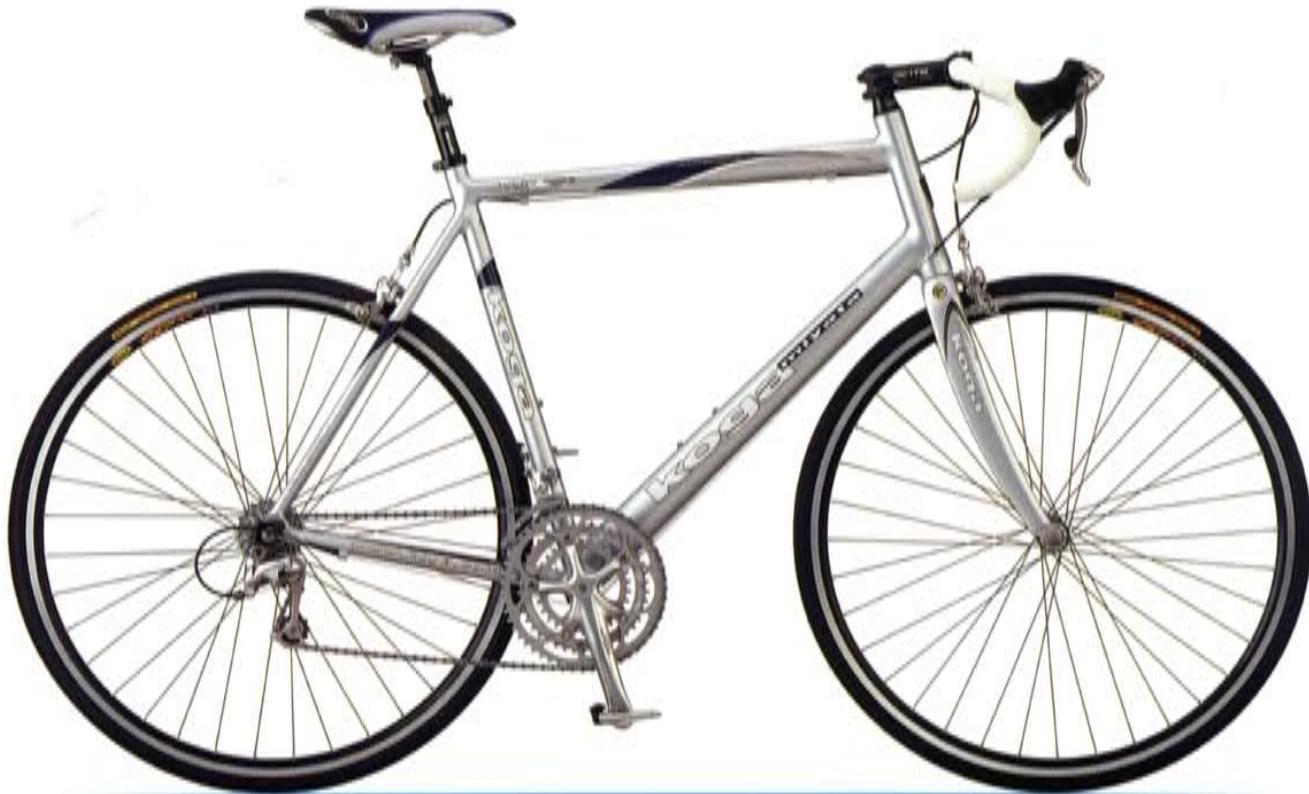
**SuperWinnerComfort (SWC)** Framematen 50-52-54-56-58-60-63cm **Framemateriaal** Aluminium 7005 **Voorwerk** Carbon Wing geïntegreerd **Kleurcombinatie** Wining silver metallic
