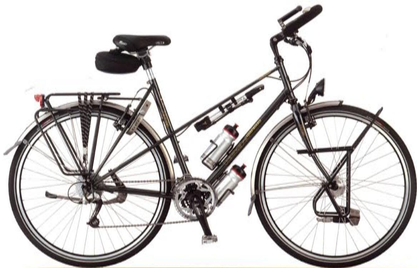
**Randonneur (RDL)** Framematen 47-50-54-57cm **Framemateriaal** Chroommolybdeen FM-1 **Voorvork** Uicrown chroommolybdeen **Kleurencombinatie** High-tech grey metallic
