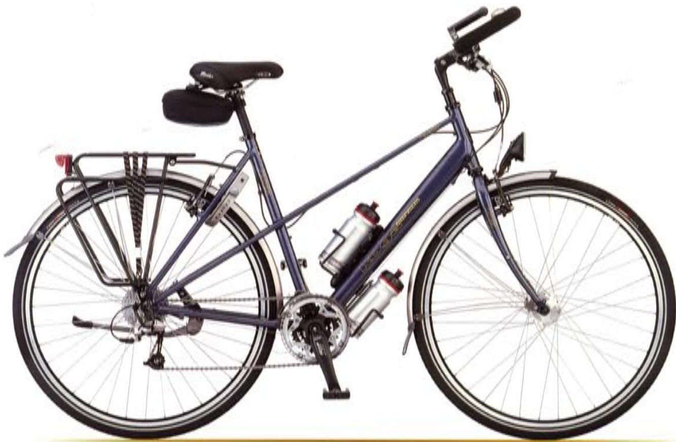
**Traveller (TRL)** Framematen 47-50-54-57cm Framemateriaal Aluminium 7005 Voorwerk Unicrown chrommolybdeen Kleurencombinatie Solent blue metallic Groep Shimano Deore LX Banden Schwalbe Marathon Plus 37-622 Zadel Selle Italia FLX Lady Leer Pedalen Koga VP-191 met industrielager Dynamo Shimano naafdynamo Nexus HB-NX30 6V/3,0W 36g 100mm Achterdrager Tukus LOGO Detailinformatie pagina 87
