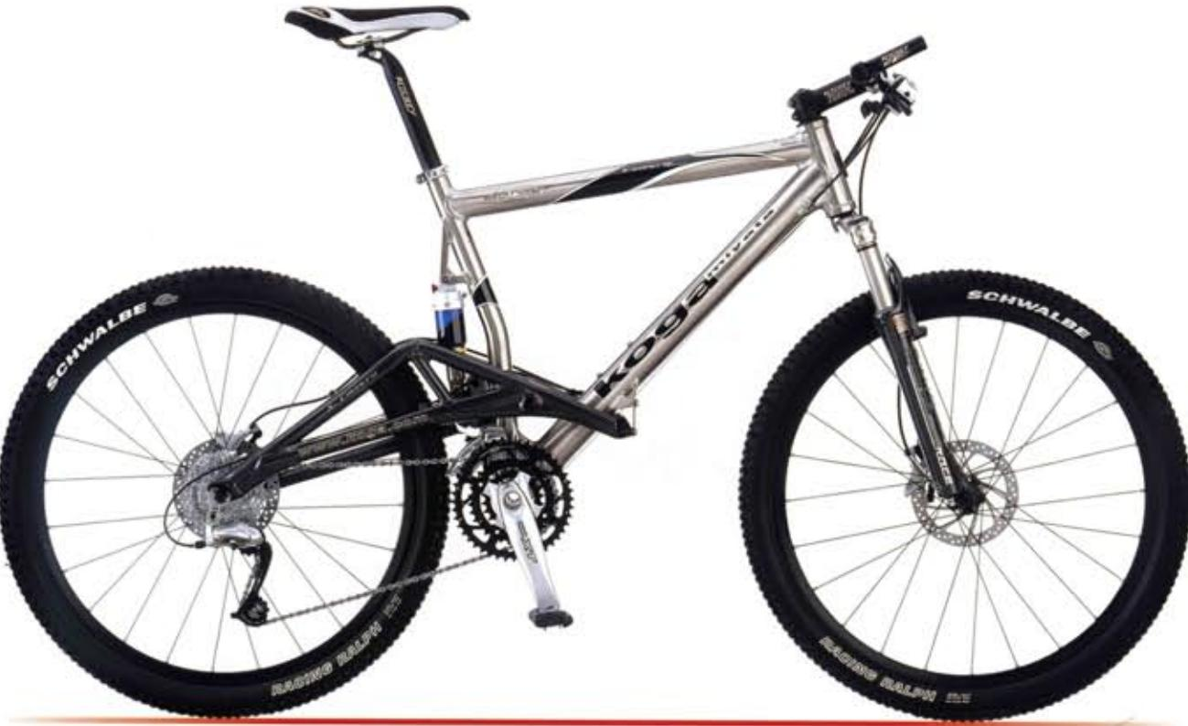
X-ControlScandium (XCS) Framematen 41-46-50-54cm Framemateriaal Scandium Voorvork Rockshox Duke Race, travel 80mm Kleurencombinatie Smoke metallic/Titanium brush Groep Shimano Deore XT incl. schijfremmen Wielset Shimano Deore XT WH-M765 Banden Schwalbe Racing Ralph Evolution 54-559 Zadel Selle San Marco ODS Zadelpen Ritchey Pro V2 Mtn ø31,4x400mm Pedalen Time Atac XS Detailinformatie pagina 81
