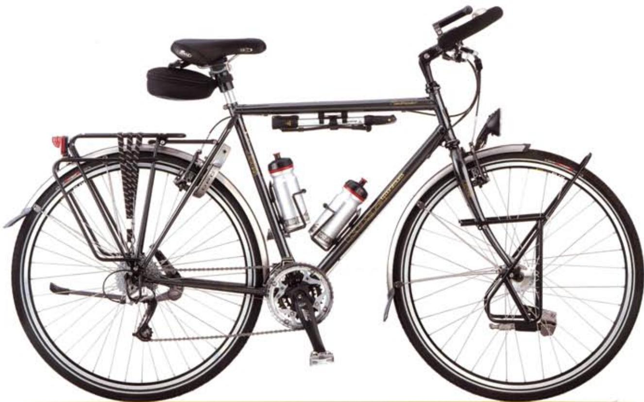
Randonneur (RD) Framematen 50-54-57-60-63cm Framemateriaal Chroommolybdeen FM-1 Voorwerk Unicorn chroommolybdeen Kleurencombinatie High-tech grey metallic
