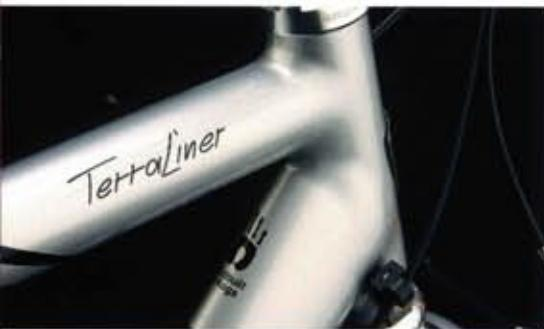
Hoogwaardig frame: stabiel, sterk en licht. De reden: buizen in een Koga-frame zijn tot driemaal gehard ('triple hardened') en de inwendige wanddikte varieert per buis tot wel driemaal ('triple butted'); voor een optimale sterkte-/gewichtsverhouding. Vloeiende afwerking van frameverbindingen (Super Smooth Welding) en diepe lakkleuren onderstrepen de unieke kwaliteit van iedere Koga-Miyata.
