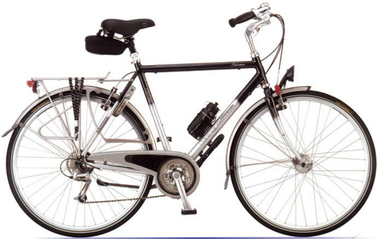
**Advance (AD)** Framematen 50-54-57-60-63cm **Framemateriaal** Aluminium 7005 **Voorvork** Uitkron chroommolybdeen **Kleurencombinatie** Koga black metallic/Winning silver metallic
