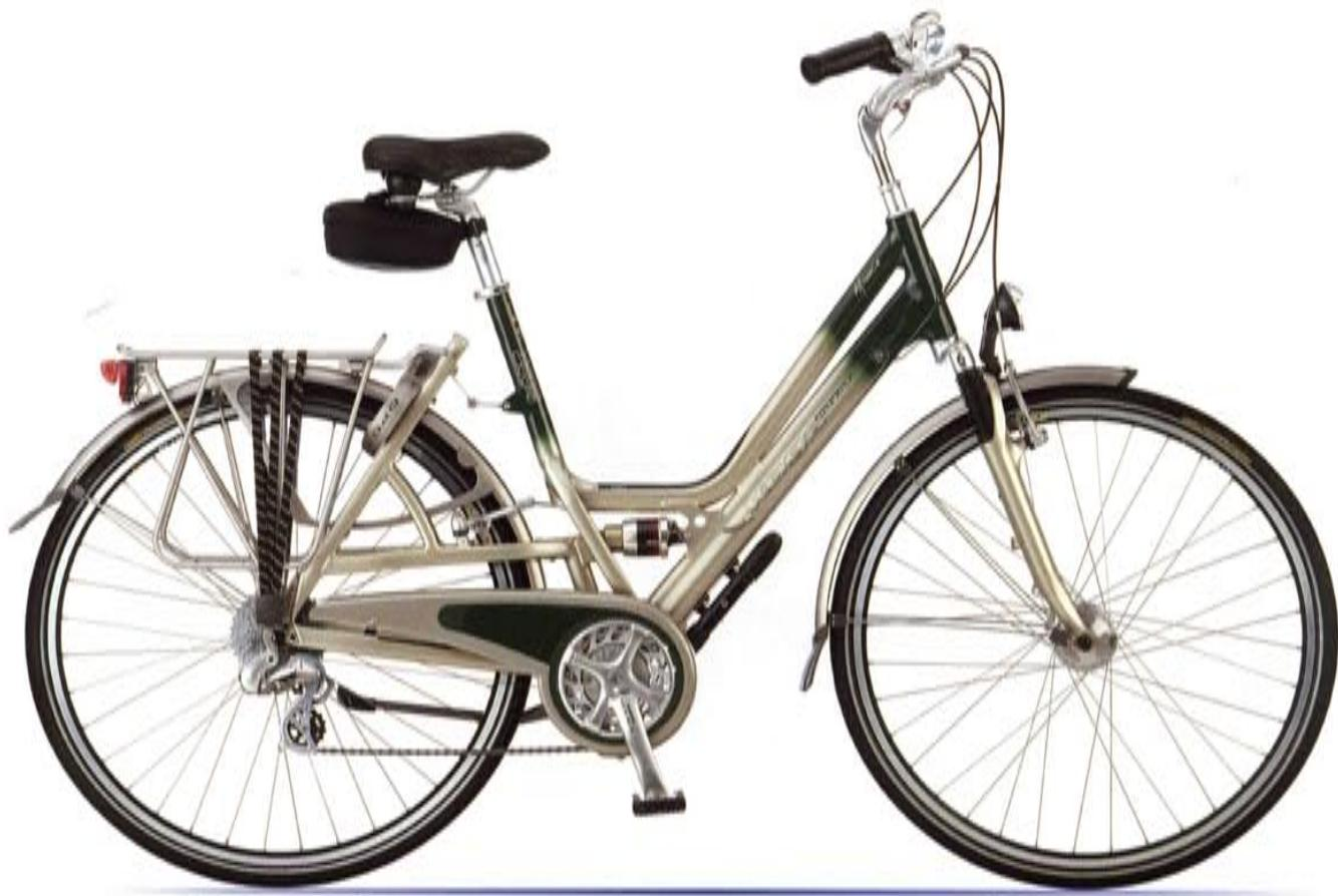
**Alliance (ALL)** Framematen 47-50-53-56-59cm **Framemateriaal** Aluminium 2006 **Voorvork** Insync Odeza LX met lock-out, voorwieg 45mm **Kleurencombinatie** Dark green metallic/
