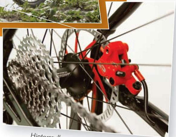
Hinterradbremse: unauffällig und geschützt an der Innenseite des Rahmens montiert. Dies verleiht dem Rahmen eine aufgeräumte Optik.
