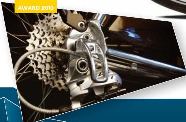
Q-guard quick release (Schnellspanner) mit integriertem Schaltwerkschutz. Durch die Integration beider Funktionen ist eine neue und innovative Komponente entstanden - leichter und attraktiver als die beiden Einzelteile zusammen.
