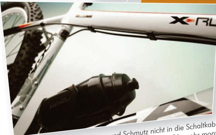
Wartungsarm: damit Schlamm und Schmutz nicht in die Schaltkabel eindringen können, wurden diese hoch unter dem Oberrohr montiert und bestehen aus einem Teil. Die Anzahl der Öffnungen im Außenrohr ist auf ein Minimum beschränkt, was perfektes Schalten für lange Zeit garantiert.
