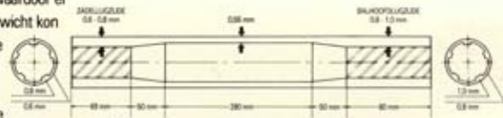
Koga-Miyata toe in haar topframesets, gebouwd met Koga-Miyata Hardtite® FM-1 chroommolybdeen spline triple-butted buizen.
